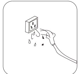
使时禁止用水淋湿电源插座和产品，以确保安全。更换电源线必须由厂家指定的专业技术人员更换，其他任何人员未经授权不得私自拆卸、更换电源线，以免引起事故。
