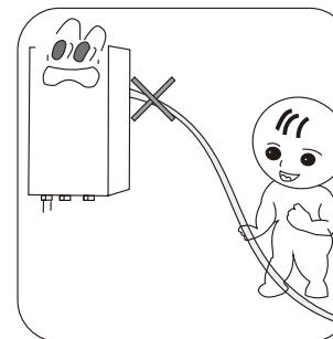
即使设备与电源断开连接，也不得拉扯、切断和扭曲电源线。
